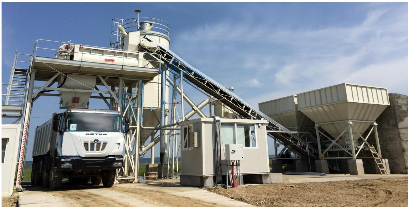
Модернизированная грунтосмесительная установка ДС-50БМ (250 куб.м. в час)
