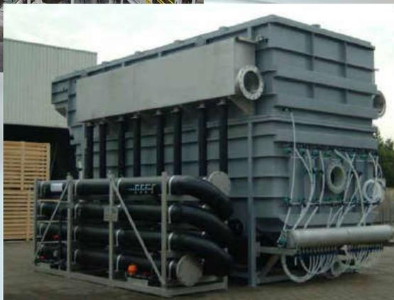
*Флотационные установки Hydromatic очень компактны, благодаря использованию технологии разделения пластин, работающей с перекрестным потоком.*
