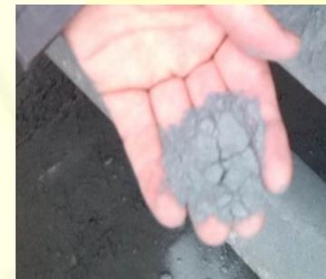
**ИЗ КОТЛОВ С КИПЯЩИМ СЛОЕМ ВЫХОДИТ ЗОЛА ИСКЛЮЧИТЕЛЬНО В ВИДЕ ТОНКОДИСПЕРСНОГО ПОРОШКА!**
